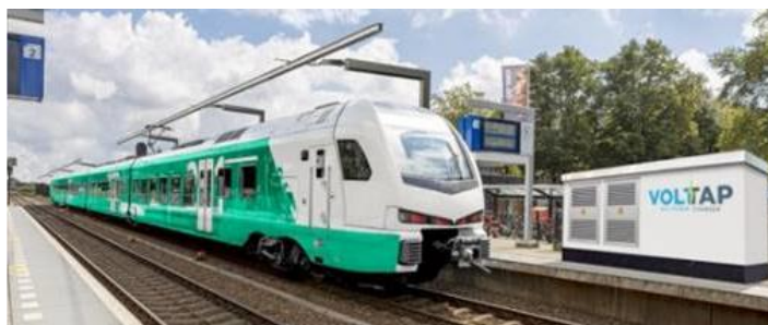
Obr. 7 Příklad dobíjení vozidla pod pevnou trakční trolejí
