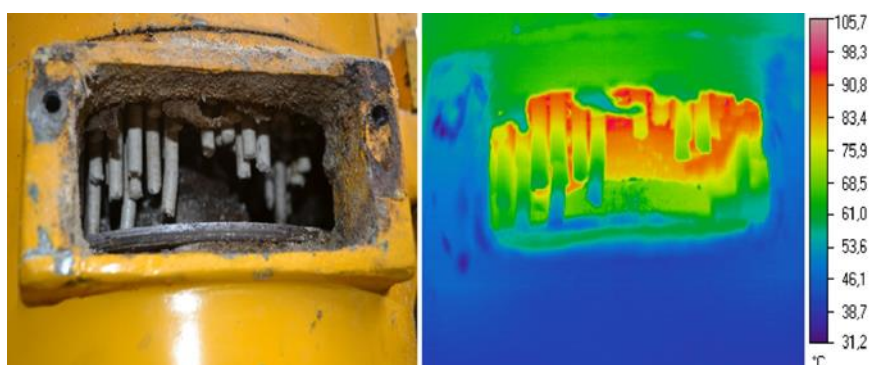
Obrázok 14 Termografická analýza teploty peliet pri lisovaní
