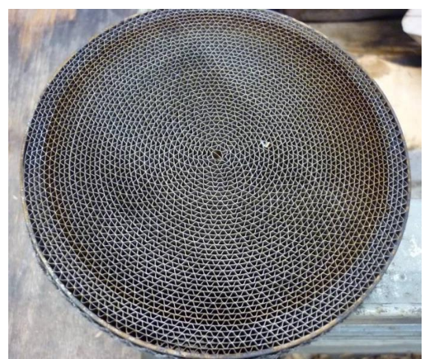
Pt katalyzátor s kovovou nosnou mriežkou
