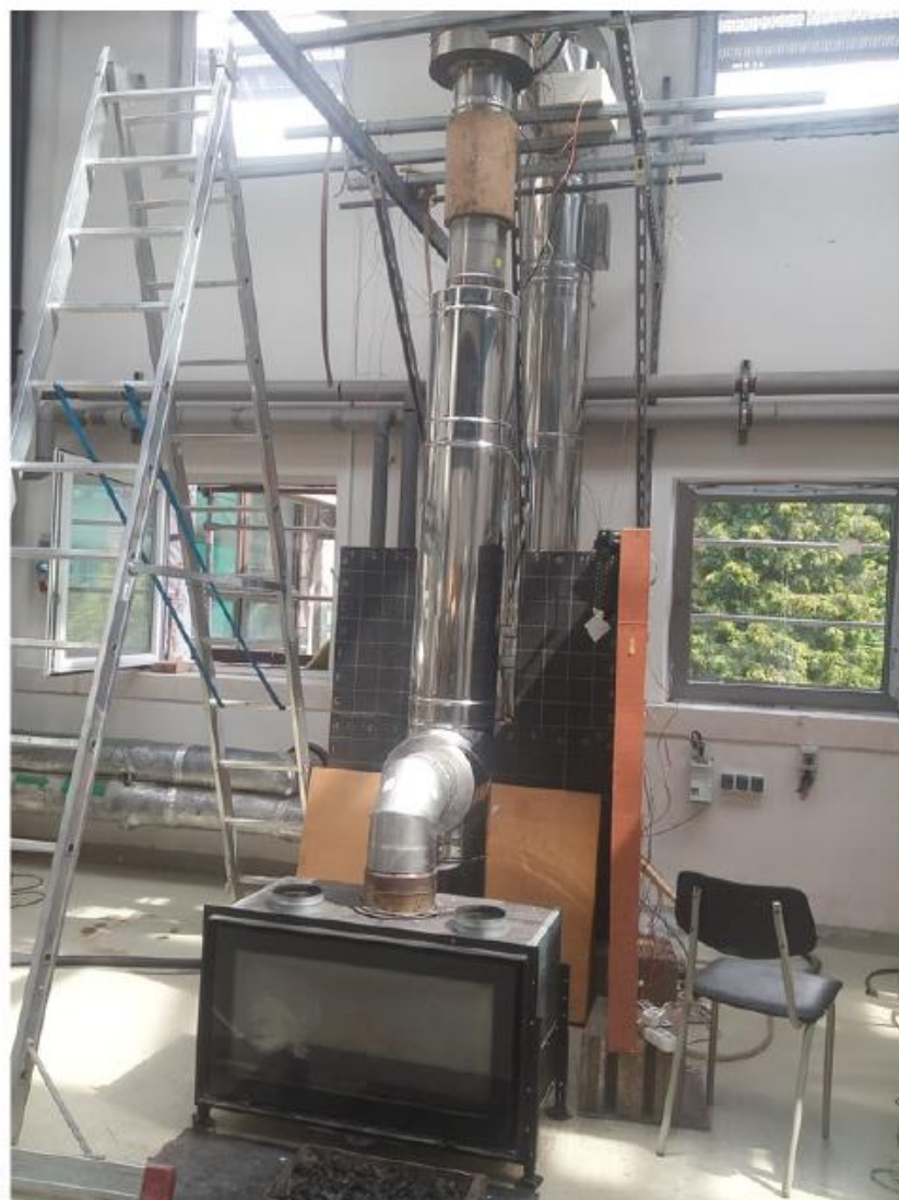
jednorúrovňový elektrostatický odlučovač účinnosť 66%
