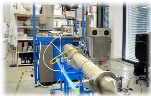
Systém pro tepelnou likvidaci nebezpečného odpadu
