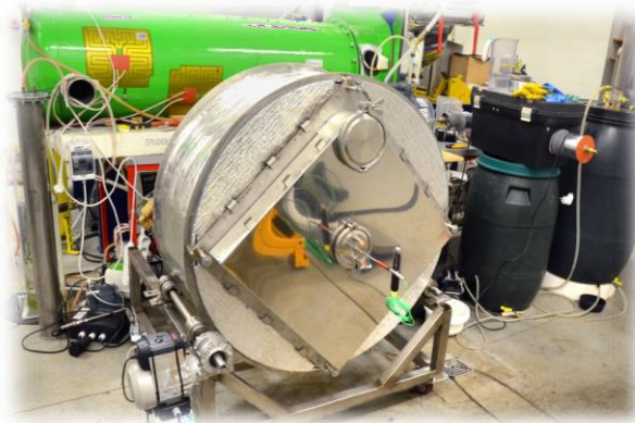
Poloprovozní anaerobní bioreaktor (fermentor)
