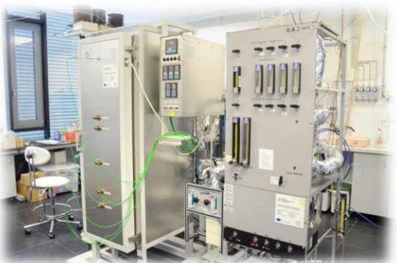
Jednotka pro testování katalyzátorů v laboratoři ochrany ovzduší
