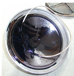
obr. č. 13 Zadehtovaný držák filtru po odběru TZL po zkoušce 3-1
