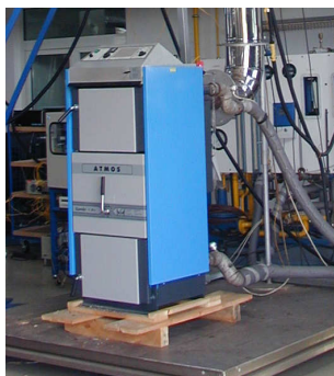
obr. č. 17 Kotel na váhovém mostu
