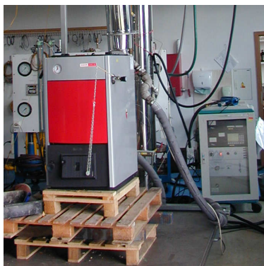
obr. č. 15 Kotel umístěný na váhovém mostu
