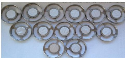
obr. č. 17 Folie nastříkány sprejem DEKATI a vloženy do sběrných kroužků
