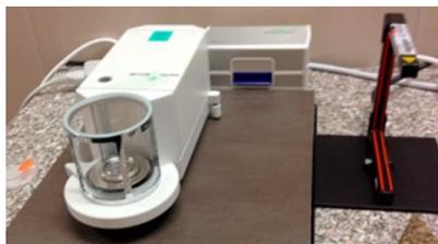
obr. č. 18 Mikrováha Mettler Toledo XP6
