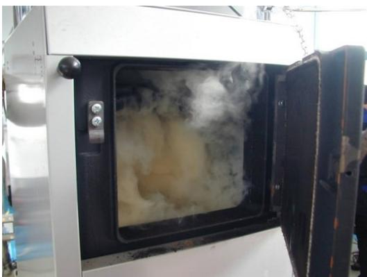
*obr. č. 34 Kotel Viadrus Hercules U26, kouř ve spalovací komoře po přiložení paliva*
