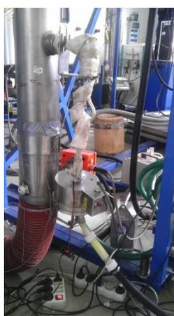
obr. č. 20 Odběr TZL pomocí cyklonu
