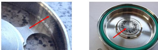
obr. č. 19 Přetížení impaktoru DLPI
