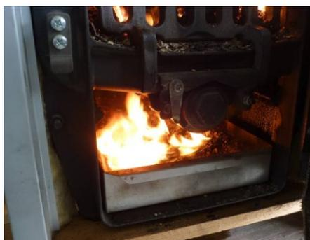
obr. č. 36 Kotel Viadrus Hercules U26, hořící olej v popelníku, palivo MIX
