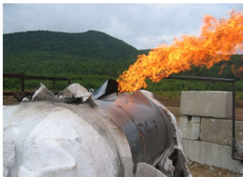
Obrázek 1: Ukázka jevu jet fire na LPG [foto z experimentů norského Sintef 1 ]
