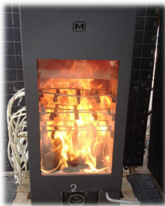
Obrázek 5 Krb o jmenovitém výkonu 6 kW
