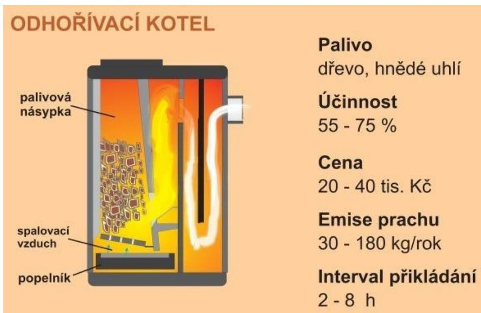
Obr. 2 Funkční schéma odhořivacího kotle
