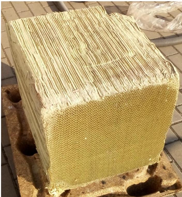
*Obr. 2 Blok katalyzátoru před začátkem testování*
