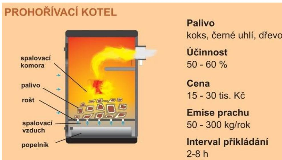
Obr. 1 Funkční schéma prohořivacího kotle
