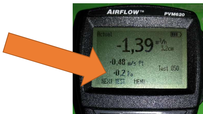
Obrázek 6 Odečet diferenčního tlaku z displeje vyhodnocovací jednotky AirFlow PVM620
