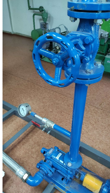
Obrázek 12 Analogový manometr pro měření relativního tlaku na výtlačku čerpadla a jeho umístění na výtlačném potrubí před regulačním vřetenovým ventilem
