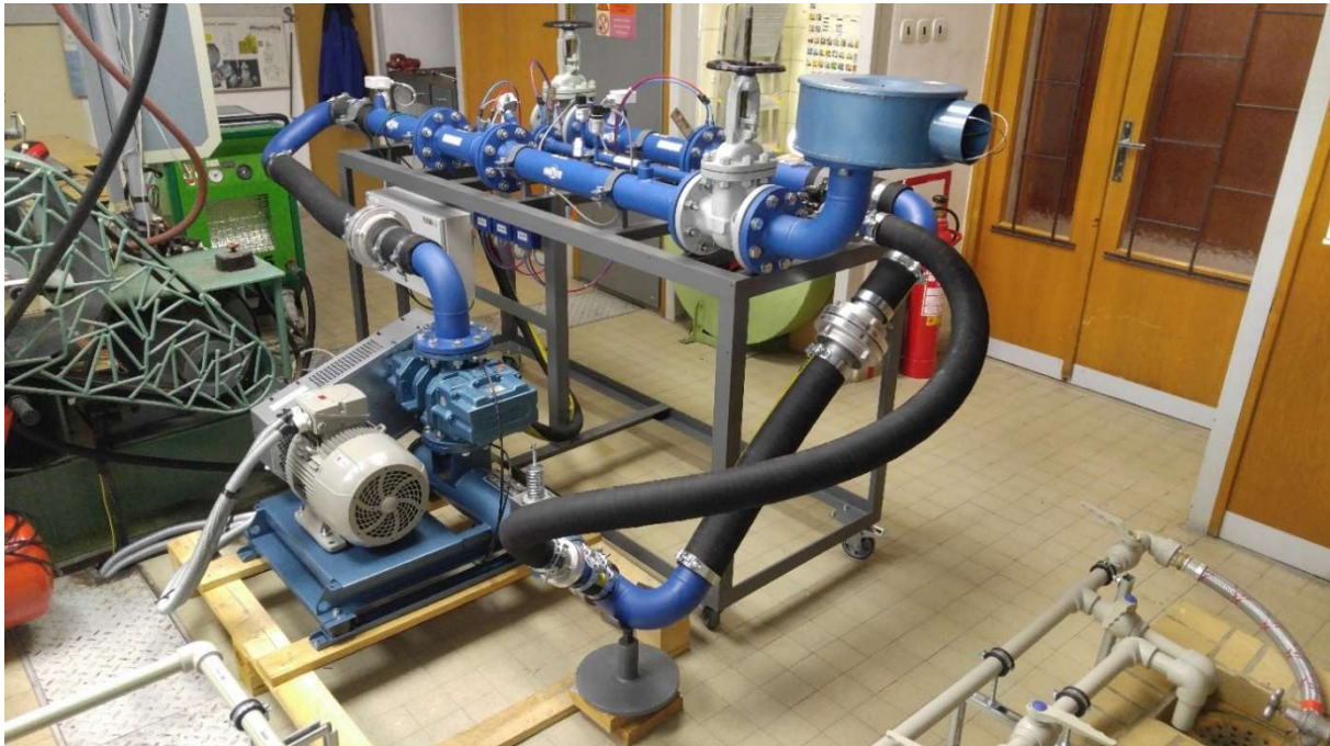
Obrázek 8 Experimentální měřicí stand pro měření Rootsova dmyhadla ve stand-by režimu před měřením
