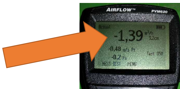
Obrázek 9 Odečet objemového průtoku v místě měření z displeje vyhodnocovací jednotky AirFlow PVM620
