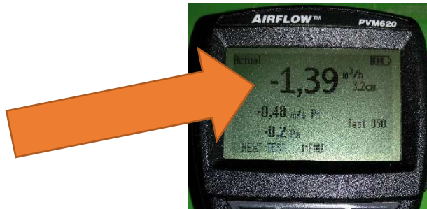
Obrázek 17 Odečet objemového průtoku v místě měření z displeje vyhodnocovací jednotky AirFlow PVM620
