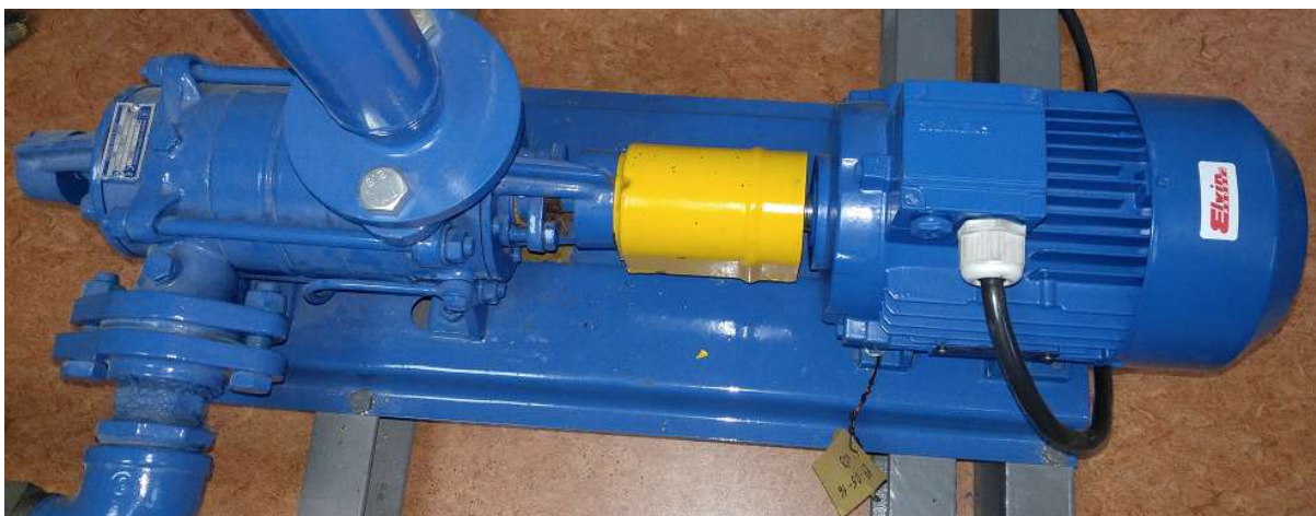
Obrázek 1 Dynamické, radiální, odstředivé, článkové a horizontální čerpadlo od výrobce Sigma 32-CVX-3-LC-010-9
