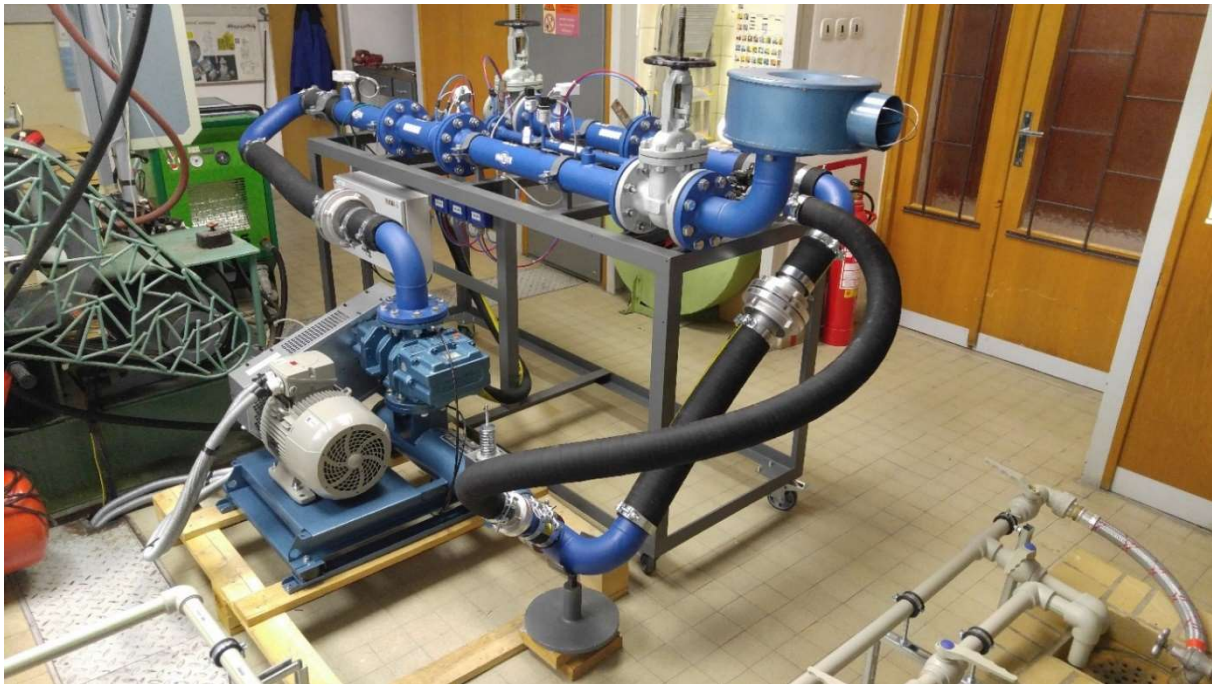
Obrázek 15 Experimentální měřicí stand pro měření Rootsova dmychadla ve stand-by režimu před měřením
