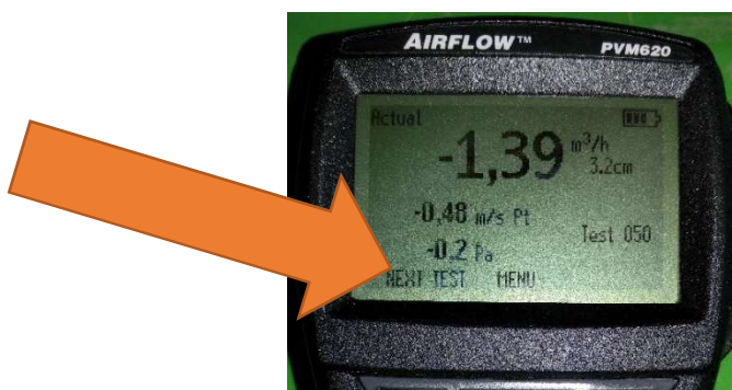
Obrázek 16 Odečet diferenčního tlaku z displeje vyhodnocovací jednotky AirFlow PVM620
