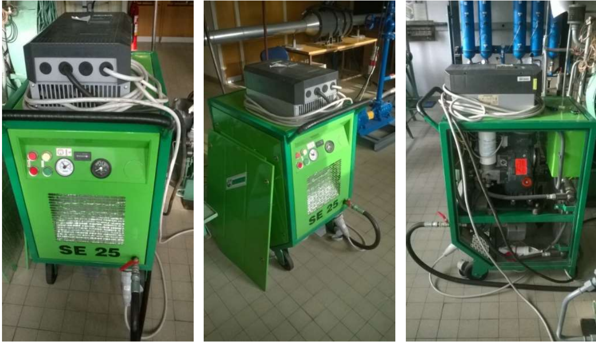
Obrázek 2 Stabilní kompresorová jednotka SE 25 s integrovaným šroubovým kompresorem NK 40
