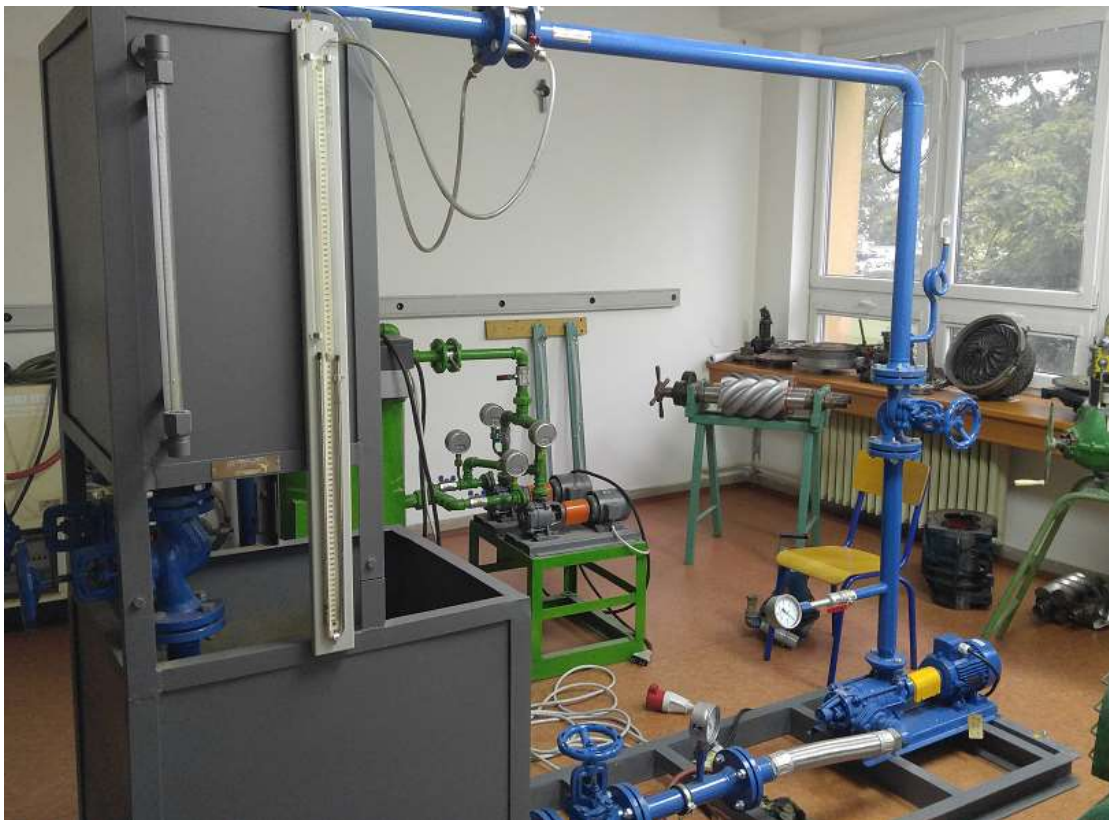
Obrázek 15 Fotografie měřicího standu s dynamickým odstředivým čerpadlem 32-CVX-3-LC-010-9
