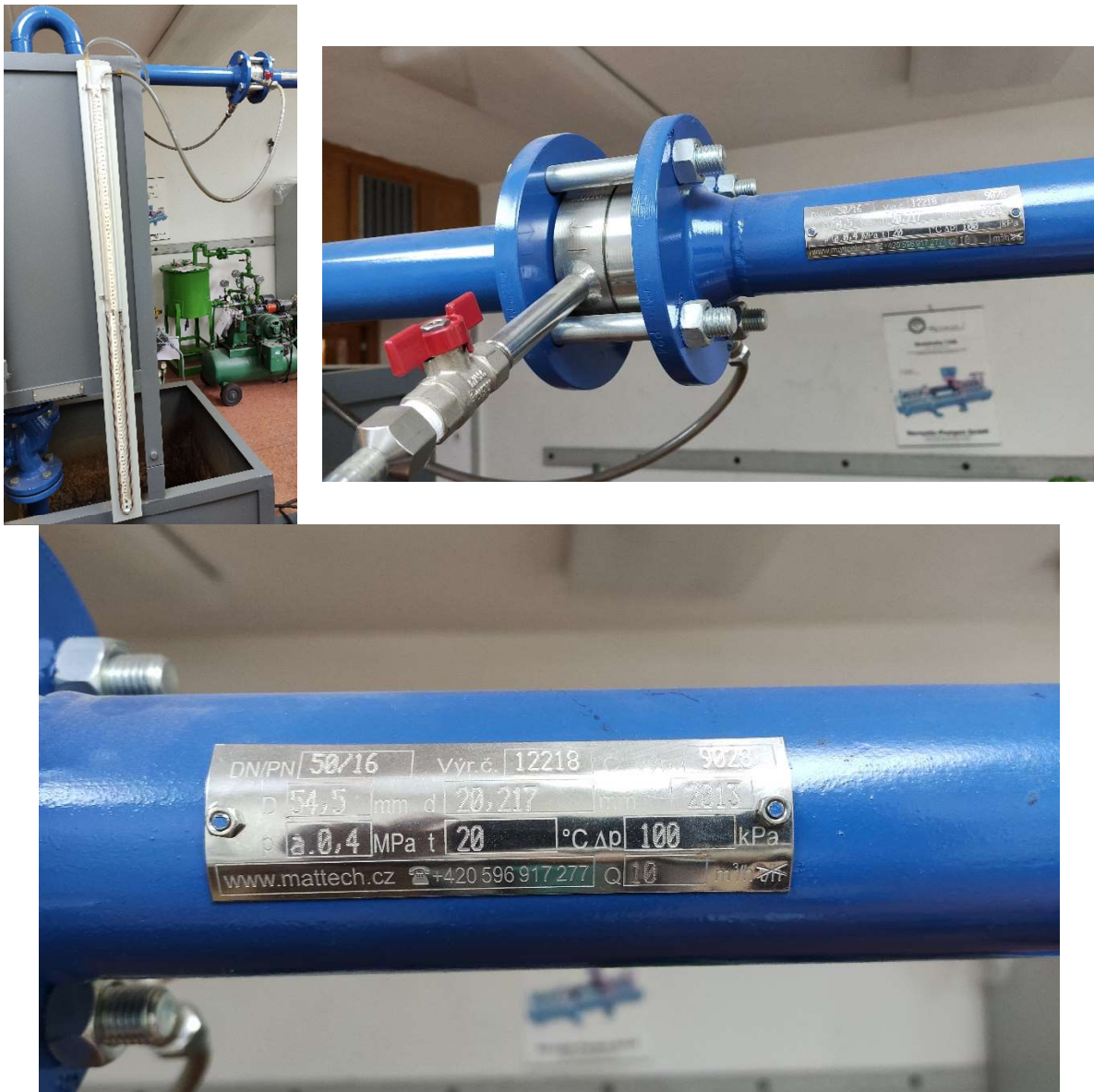
Obrázek 8 Centrická clona DN50 PN16 s komorovým odběrem tlakové difference
