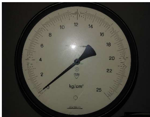
Obrázek 13 Manometr k měření statického tlaku na cloně
