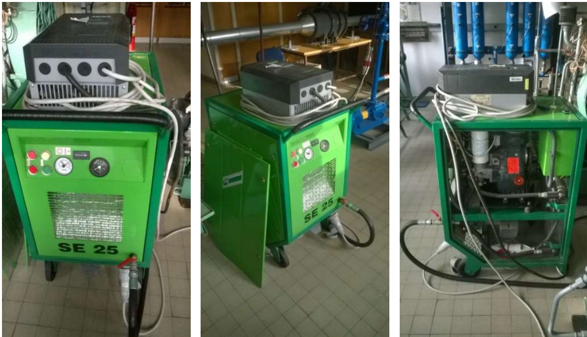
Obrázek 1 Stabilní kompresorová jednotka SE 25 s integrovaným šroubovým kompresorem NK 40
