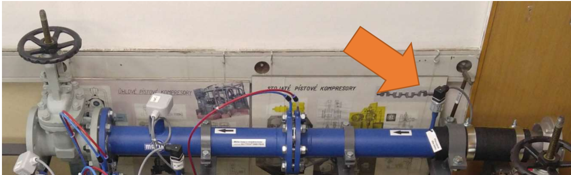
Obrázek 3 MT3 Měřicí trať s vícevzorovou clonou DN80 PN16 a výstupním plnopřůčným šoupětem
