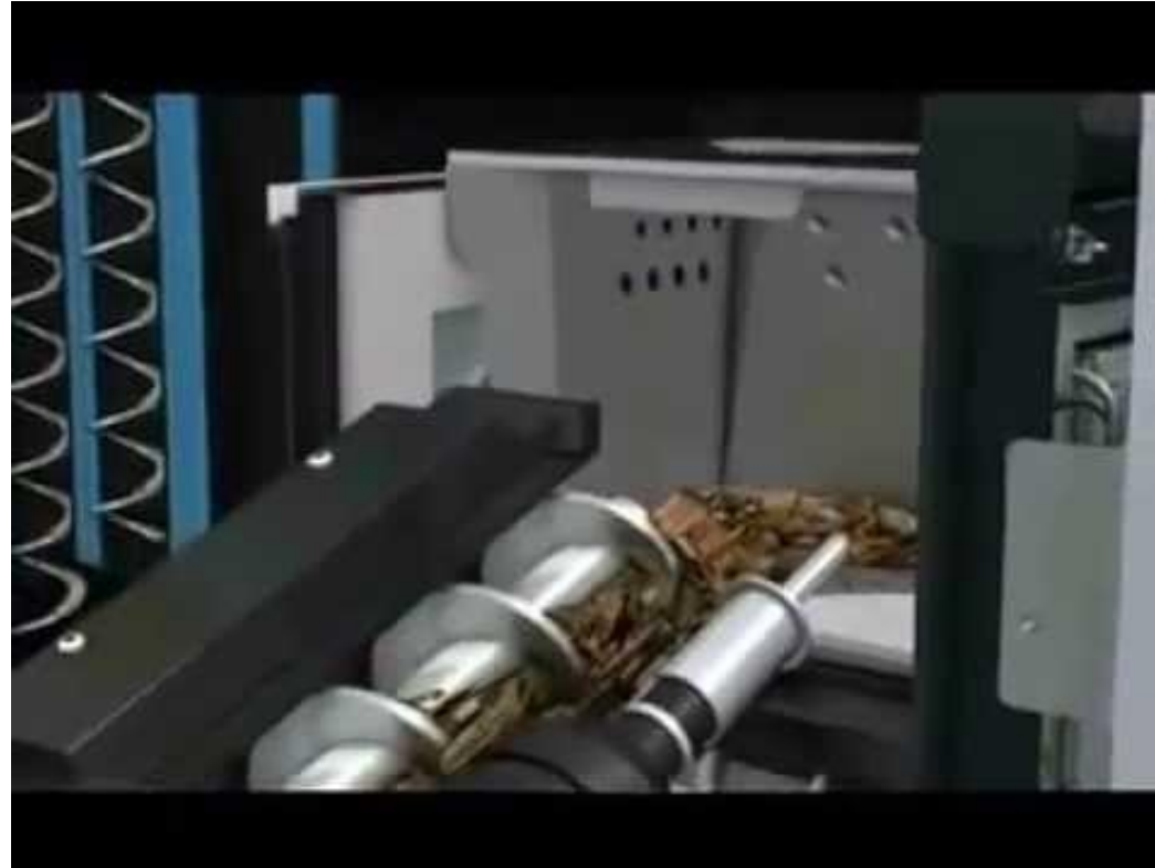
Kotel s retortovým ohništěm
