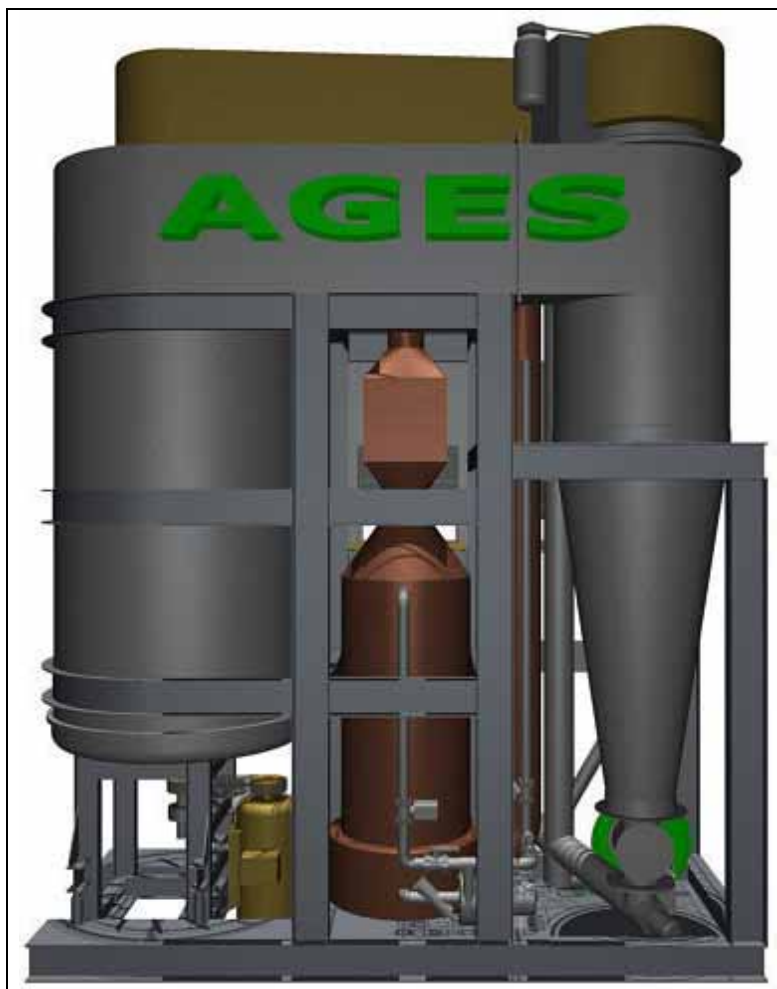
Obr. 5.6. Zařízení k separaci vlhkosti zastudena a dezintegraci paliva kinetickou energií
