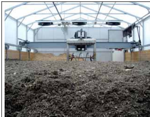
Obr. 5.29. Příklad portálového robotu pro obsluhu skládky paliva, na snímku je patrné kypřící zařízení, které může být nahrazeno např drapákem a jinými nástavci
