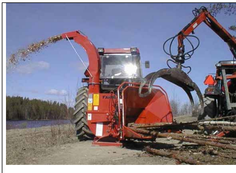
Obr. 5.1. Mobilní štěpkovač dřevního odpadu přivěšený za traktor
