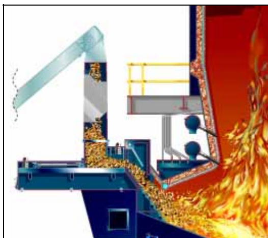
Obr. 5.40. Princip činnosti vtlačovacího lisu
