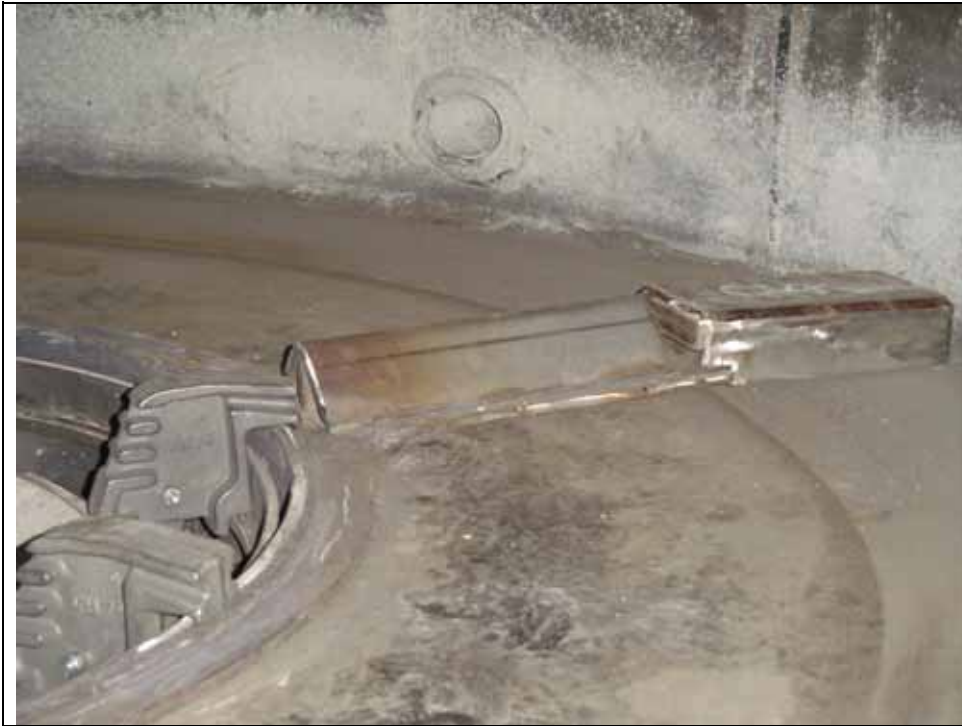
Obr. 5.45. Odškvárovací zařízení v topeništi s podsuvným roštem, patky jsou unášeny středovým prstencem po pevném dně a shrnují škváru do výpadového otvoru, pod kterým je vynášecí šnek. Pro názornost obrázku jsou zde uloženy pouze dvě roštnice.
