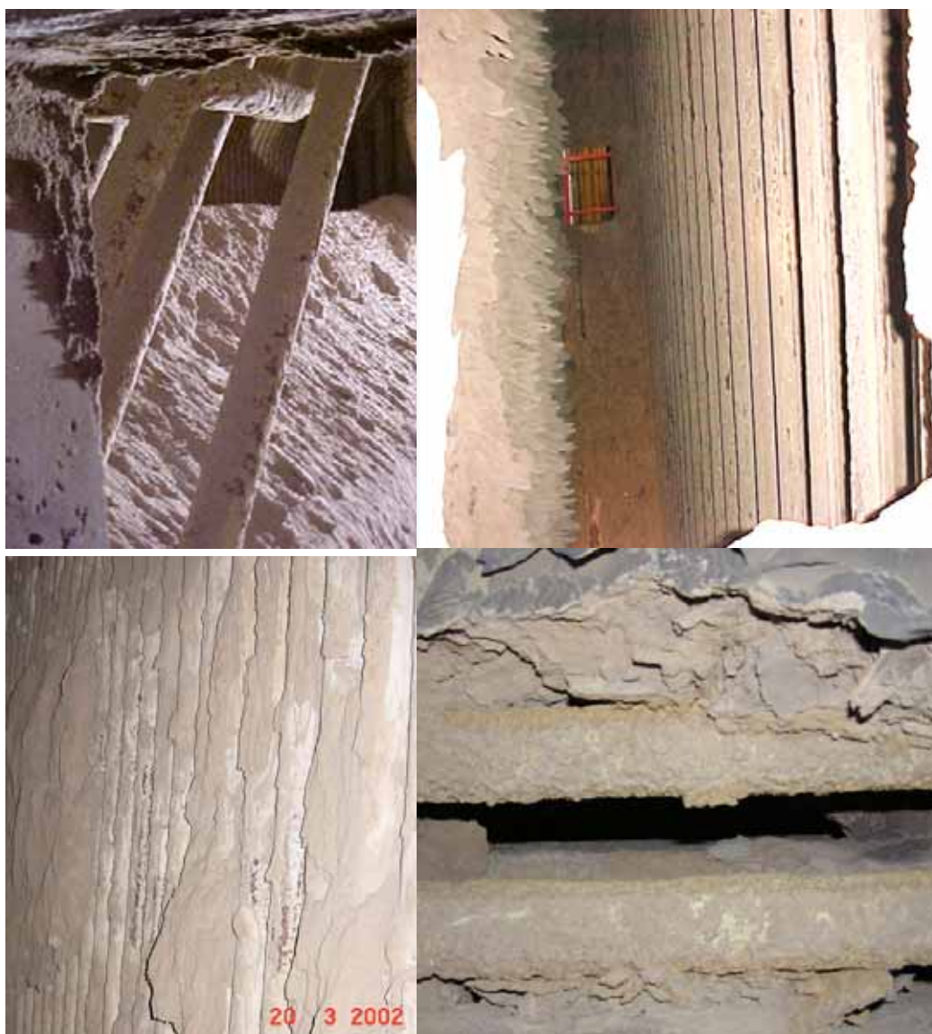
Obr. 5.48. Příklady tvorby nánosů na výhřevných plochách
