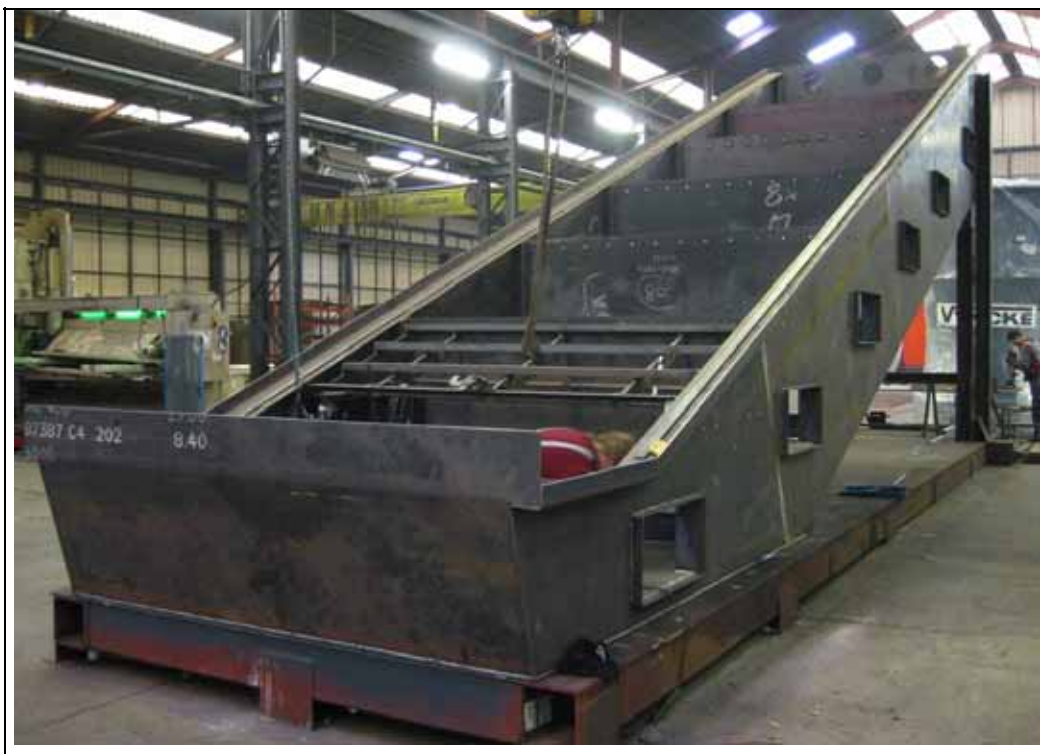
Obr. 6.22. Vzduchová pásma na holém tělese roštu systému Vyncke
