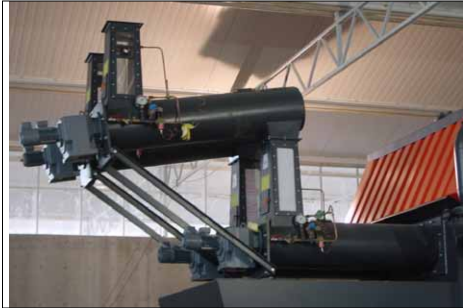
Obr. 5.37. Zdvojené podávací zařízení s podávacími šneký
