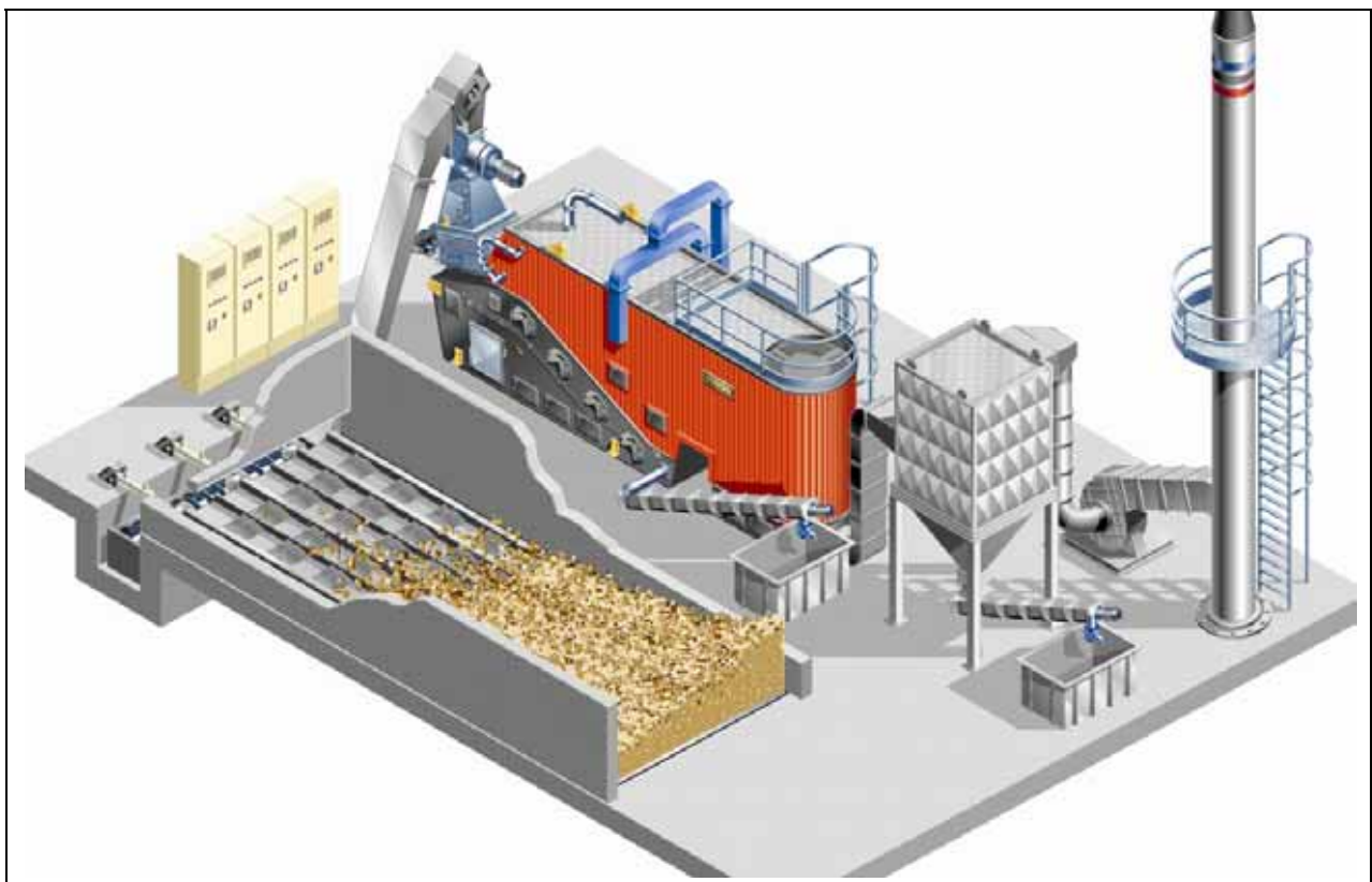
Obr. 5.46. Celkový pohled na kotelní komplex se skříňovým kotlem a šikmým prohrabávacím roštem. Je zde patrná klínová vyhrnovací podlaha, šikmý redler a šnekový podavač. Na výstupní straně roštu je patrný odškvárovací šnek a dopravní šnek popílku, který ústí do kontejneru. Totéž je i u odlučovače. Kontejnery jsou pro názornost kresleny otevřené, ve skutečnosti bývají vzduchotěsně uzavřeny.
