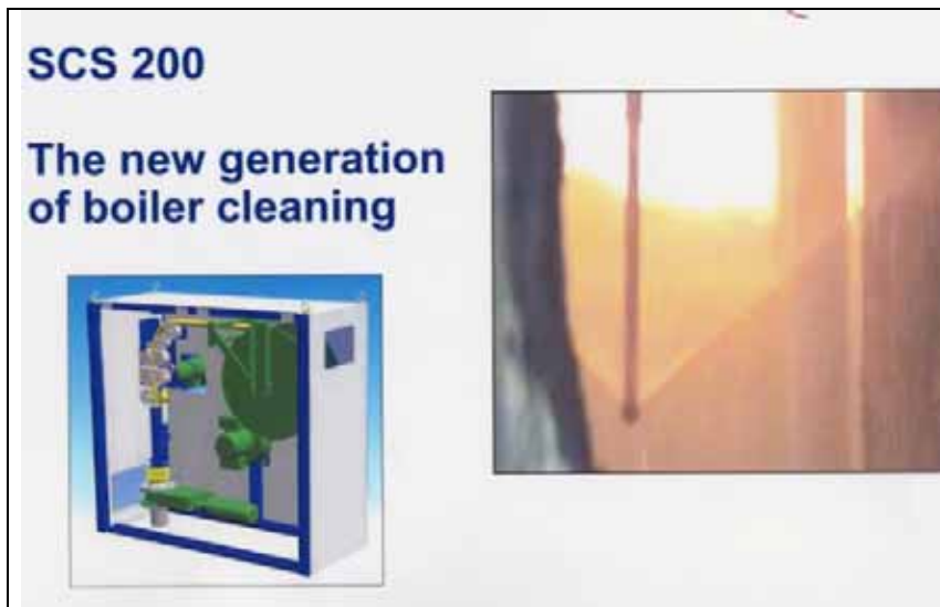
Obr. 5.63. Čištění vodní sprchou, vlevo zařízení pro vodní sprchu, vpravo praktické použití
